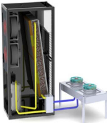
В кондиционер встроен водоохлаждаемый конденсатор, к которому подводятся трубопроводы от внешнего охладителя. Избытки тепла из охлаждаемого помещения передаются фреоновым, затем водяным (этилен/пропилен гликолевым) контурами к внешнему охладителю и рассеиваются во внешнюю среду.
